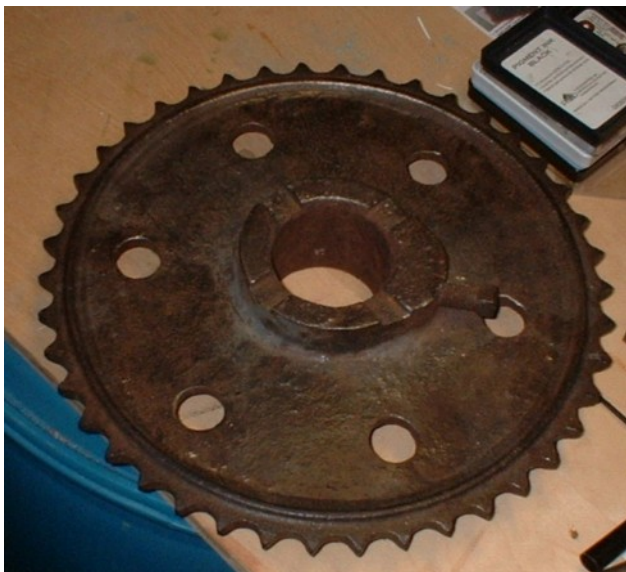
Цепное колесо 42 зубов изготовленный на заказ пришло С колесом; прикреплено к желтому колесу внутри колеса с весами
