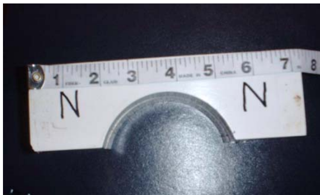
Магнит феррита бария принятый от старого жесткая диска большой ЭВМ IBM
